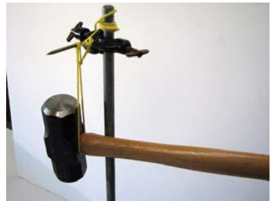
ハンマーの重心は、ハンマーヘッドに近い柄の内部に位置しています。
